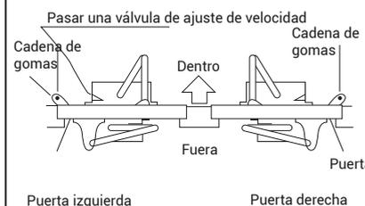
Ajustar el tornillo que controla la velocidad de paso por ambos lados. El método de ajuste es lento hacia las agujas del reloj.
