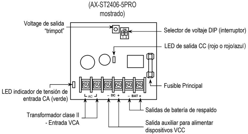
Nota: El LED, el interruptor DIP y la ubicación del terminal pueden variar ligeramente entre los distintos modelos.
